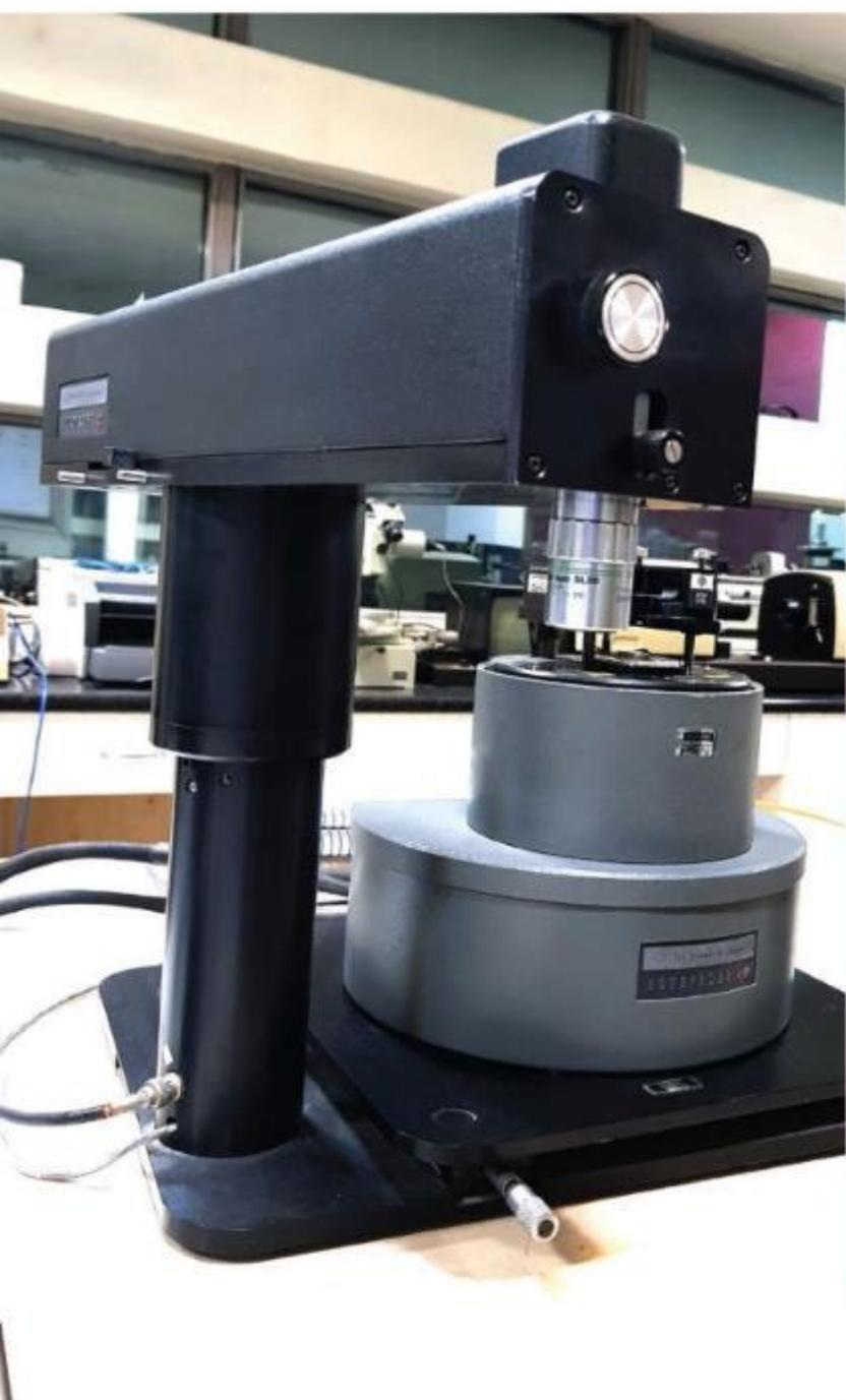
برای مشاهده ای اجسام و نمونه های با ابعاد بسیار ریز در حد مولکول های کوچک و اتم ها، نمی توان از میکروسکوپ های معمولی استفاده کرد؛ چرا که این نمونه ها، ابعادی در حد نانو دارند و میکروسکوپ های معمولی، قادر به نشان دادن این ابعاد نیستند. بنابراین برای دیدن نمونه ها با ابعادی در حد نانو، باید از ابزارهای دقیق، تر و پیشرفته تر استفاده شود. یکی از این ابزارها، میکروسکوپ نیروی اتمی (AFM) است.
