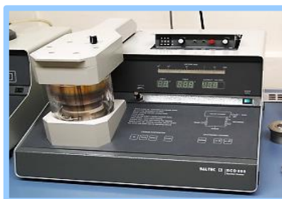
تصویر ۳: شمایی از دستگاه کندوپاش جهت پوشش دهی نمونه‌ی SEM
